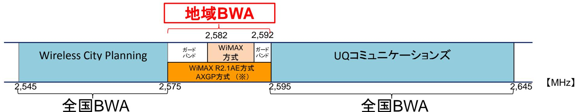
※ 国際的な標準化プロジェクトである3GPPIによって策定された『TDD-LTE』と互換性のある方式
